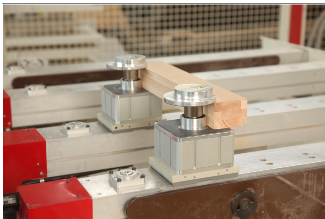
Bloccaggi meccanici VCMC-K2 per il fissaggio degli elementi dei telai
